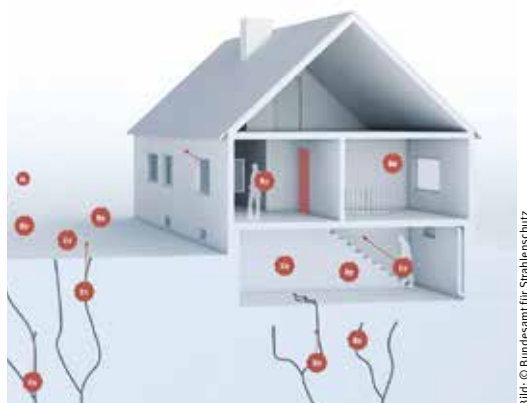
Wege des Radons aus dem Boden an die Oberfläche
