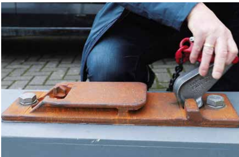
Einfädeln des Weichenschwellenhakens
