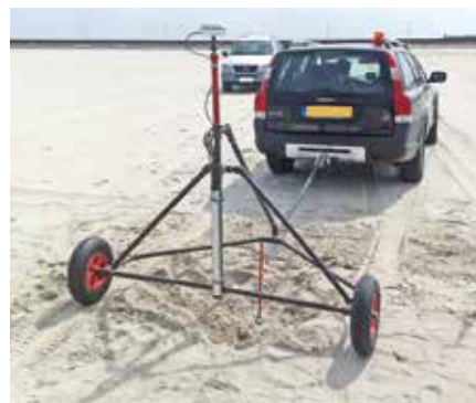
Einsatz von Sonden der Magnetik als Oberflächentechnik mit einem Fahrzeug
